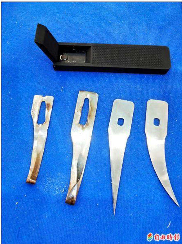
「可更換刀頭之刻花刀結構」用同一支刀柄，只需換刀頭，就有不同雕刻功能。(記者湯佳玲攝)
